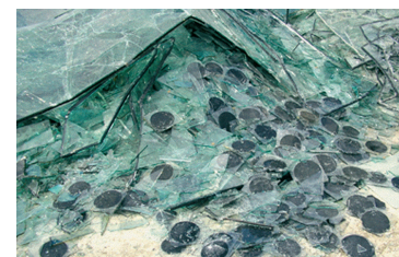
Een voorbeeld van bitumen vervuiling
